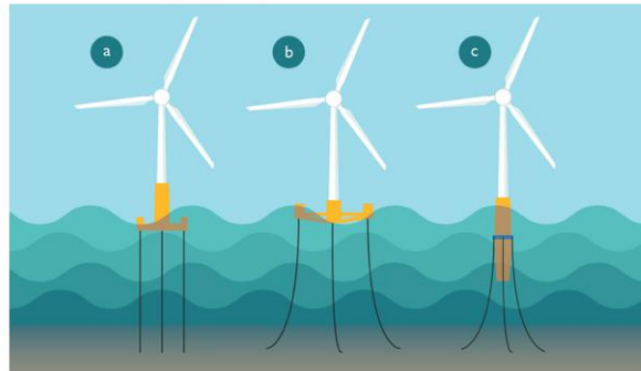
Figura 16. Tecnologías de eólica flotante: (a) plataforma de apoyo en tensión (TLP), (b) plataforma semi-sumergible y (c) monopilar flotante o "spar". Fuente: MITECO-IDAE
